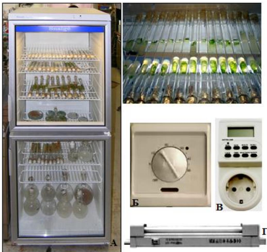
Рис. 2.1 Хранение штаммов микроводорослей
