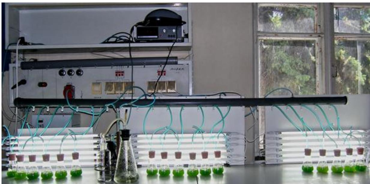
Рис. 2.2 Общий вид установки для культивирования микроводорослей в стеклянных колбах объёмом 100 мл
