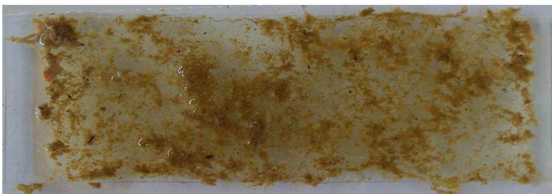
Рис. 3.32 Обрастание стеклянной пластины при сроке экспозиции в море с 23 июня по 25 июля 2011 г.
